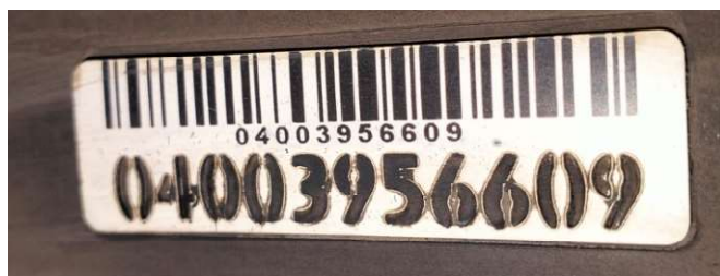
Рис. 1 Пример серийного номера грузовой шины
